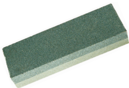
Abziehstein aus Aluminium-Oxyd, flach, kombiniert mit zwei Körnungen grob/fein, mit Öl oder Wasser zu verwenden, für Stahlwerkzeuge und feine Schneiden
