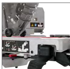
Gelasierte Winkelskala von 52° L / 60° R. Mit Winkelrastpunkten von 0°, 15°, 22,5°, 31,6°, 45° L / 0°, 15°, 22,5°, 31,6°, 45°, 60° R. Leicht ablesbar und exakt einstellbar durch selbst-erklärende Bedienelemente
