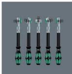
Der Knarrenkopf ist frei schwenkbar und kann durch den beidseitig angebrachten Schiebeschalter in jeder Fixierungsposition verriegelt werden. Problemloses Arbeiten mit großem Handfreiraum ist selbst in sehr engen oder schwer zu erreichenden Einbausituationen möglich. Die definierte Fixierung bei 0°, 15° und 90° nach links und rechts garantiert sicheres Arbeiten ohne Verrutschen des Knarrenkopfes.
