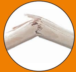
Das Hickory-Holz der Stiele in den SecuTec® -Hämmern hält durch seine langen Fasern den Stiel auch bei einem Bruch zusammen.
