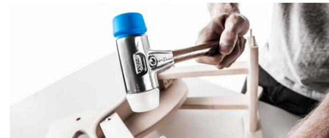
**Anwendung: Schreinerarbeiten, Möbelbau, Fenster-/Türenbau, Positionieren von leichten/empfindlichen Werkstücken**
